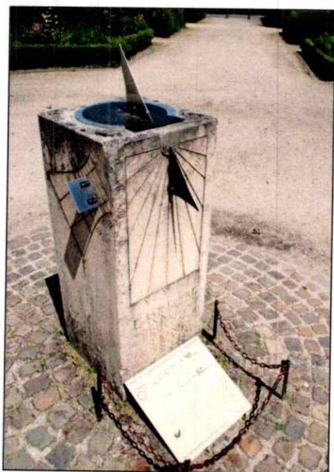
Fig. 2. De zuil met de horizontale Sawyer Equant en drie verticale zonnewijzers.
