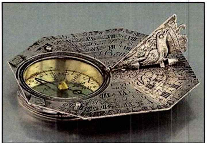
Foto 5: Bij de Butterfield-zonnwijzer is het kompas naast de wijzerplaat ingebouwd. Deze laatste kon daarvoor vollediger en exacter worden uitgewerkt, waardoor de zonnwijzer nauwkeuriger was. Bovendien was de poolstijl ook verstelbaar, waardoor de zonnwijzer op verschillende breedtegraden kon worden gebruikt.
